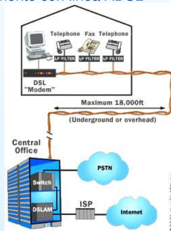
Figura 1: esempio: collegamento con linea ADSL
